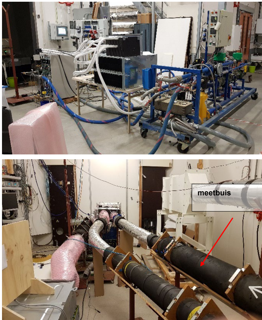
Figuur 19. Hardware in labopstelling. Op de bovenste afbeelding zijn van links naar rechts te zien: de deur naar de klimaatkamer; de compressorunit, de twee dummy-toestellen en de selectiebox; de opstelling voor simulatie van de circulatieleiding. Op de onderste afbeelding zijn te zien: de ventilatorconvector (linksonder), het WTW-toestel (midden achteraan) en het filterhuis (rechtsboven). De drie kanalen met zwart isolatiemateriaal zijn de meetbuizen.
