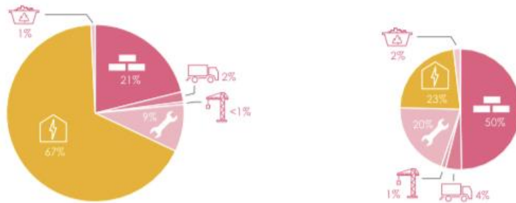
Figuur 1: Aandeel operationele energie (oranje) en materiaal (roze) in totale emissies. Verhouding voor de bestaande bouw (links) en energie-efficiënte gebouwen 2030 (rechts) 2
