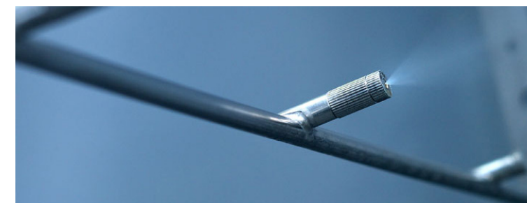
Figuur 7. Perslucht uit nozzles verneveld onder hogedruk. 26
